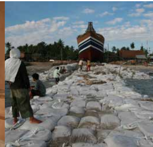
Stapellauf mit Muskelkraft: Die Amira wurde zentimeterweise ins Wasser gezogen.
